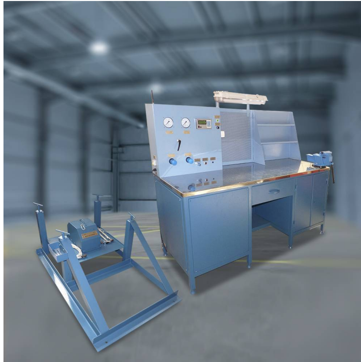
Специализированное рабочее место контроля токоприемников (СРМ-АЦ ПГ)
