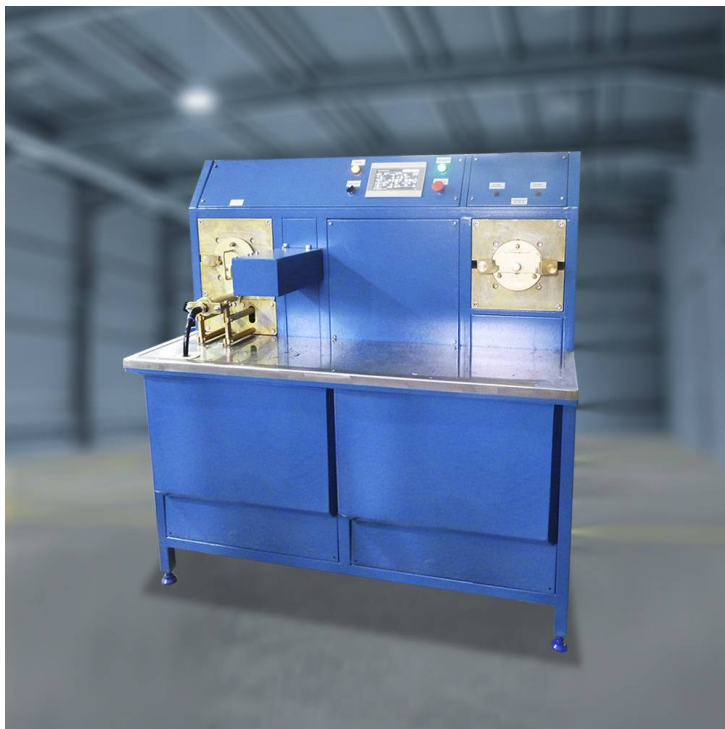
Пост контроля воздухораспределителей (КСК.3-АвЦ ВР)
