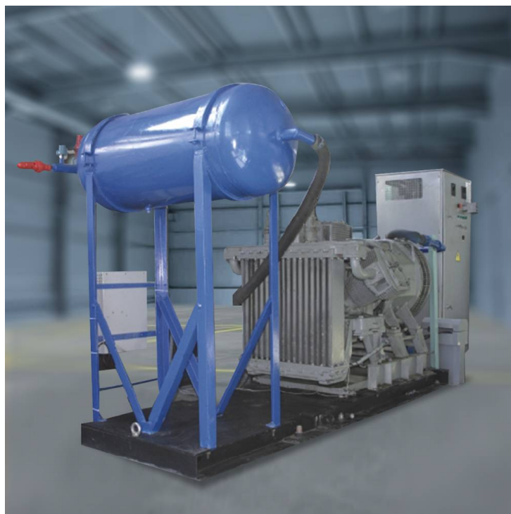
Испытательная станция компрессоров (ИС КП)
