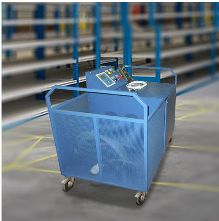
Стенд для обслуживания и проверки быстродействующих выключателей вагонов метро (СПЭ-14)
